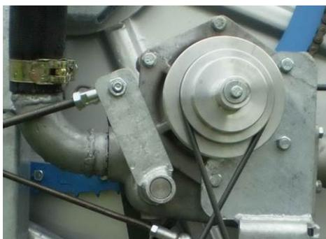
La turbine à courant principal Ti 7-A de conception spéciale se distingue par de grandes sections transversales de passage et de petites pertes de pression. Cela permet d'atteindre de hautes vitesses d'enroulement avec une petite quantité d'eau. La turbine fournit l'énergie nécessaire pour l'enroulement du tube PE. La vitesse est prise directement de l'arbre de roue mobile et elle est transmise à la boîte des vitesses par le biais d'un mécanisme à courroie trapézoïdale à 3 étapes.
