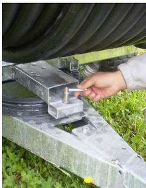
Pour détacher le tube PE de côté, sortez le boulon de retenue, tournez le tambour dans le sens de la ruelle d'arrosage et refixez-le avec le boulon de retenue.
