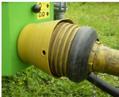
Le cas échéant le tube PE peut également être enroulé par le tracteur à l'intermédiaire d'un cardan. Mettez le levier de changement de vitesse à la position "Enroulement par tracteur".
