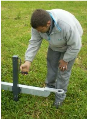
Mettez l'appareil dans une position horizontale à l'aide de la béquille de timon.
