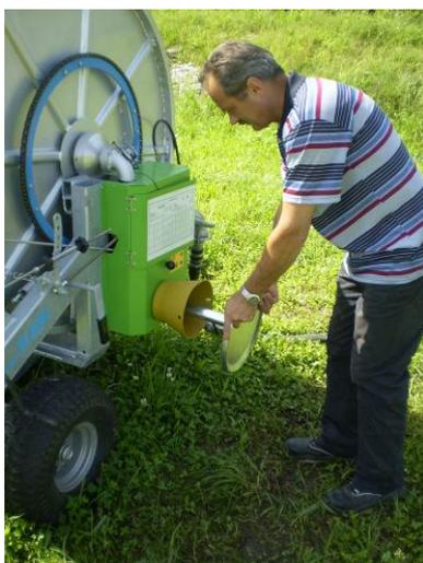
Pendant l'entraînement par cardan l'arrêt final automatique est hors service. Il faut donc arrêter à temps l'arbre cardan et enrouler à main la dernière partie du tube en se servant de la roue à main. On évite ainsi l'endommagement par violence du traîneau, du dispositif d'arrêt, de l'engrenage, etc.
