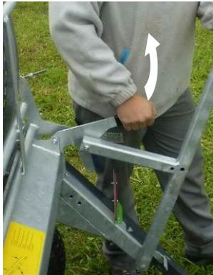
Dès que le traîneau se trouve en position de travail, déverrouillez-le mécaniquement. Poussez le crochet de verrouillage vers le haut.
