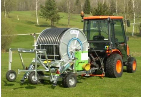
Pour le transport, tournez le tambour dans le sens de la marche et le fixez-le par le boulon de retenue. Le frein du tambour doit être actionné. Le traîneau, la béquille de timon ainsi que les deux béquilles arrières de l'appareil doivent être levés et/ou rentrés. Lorsque le tube PE sera détaché de côté, placez le RAINSTAR A3 au bord du champ à angle droit à la bande d'arrosage et dételez-le du tracteur.
