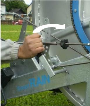
Actionnez le frein du tambour. Maintenant l'enroulement du tube PE peut être arrêté immédiatement en actionnant le palpeur ou le levier de changement de vitesse. En faisant cela, la boîte de vitesse est débrayée. Relâchez lentement le tube PE en ouvrant légèrement le frein du tambour.
