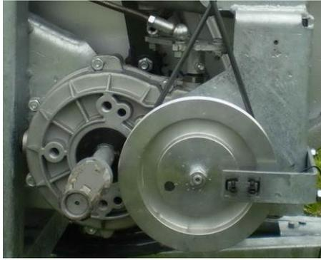
La boîte des vitesses est munie des roues dentées qui réduisent la vitesse de turbine. L'entraînement du tambour à la fin de la bande d'arrosage est arrêté par le désaccouplement de l'embrayage à denture.
