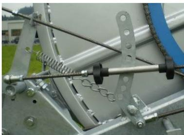
... il actionne une came de réglage par le biais de la timonerie de réglage. Cette came de réglage est montée directement sur la turbine et elle sert à régler le nombre des tours de la turbine.
