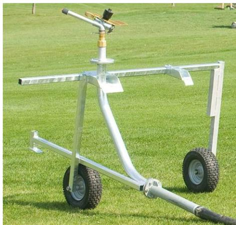
Grâce à sa haute construction, le traîneau à roues protège très bien les cultures. La voie est réglable en continu permettant l'ajustage à n'importe quel écartement entre rangées. Le traîneau est équipé d'un crochet pour faciliter le détachement du tube PE.
