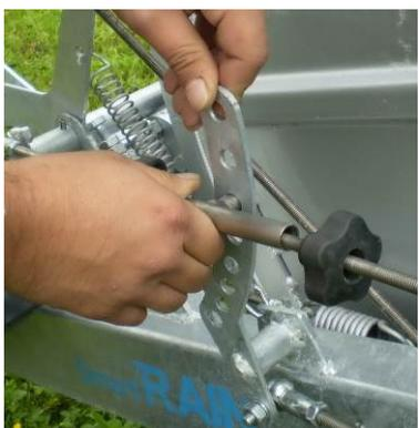
Les différentes conditions de sol et de petites quantités d'eau peuvent causer une vitesse d'enroulement inconstante malgré le système de compensation des couches. Pour remédier cette situation, on peut changer le trou de la tringle de réglage pour accélérer ou décélérer l'enroulement du tube PE.
