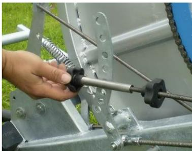
La vitesse d'enroulement est réglable en continu à l'aide de la tringle de réglage. Celle-ci est arrêtée après le réglage par les molettes. La vitesse est quasi constante de la première à la dernière couche et aussi dans une même couche et la vitesse est réglée de la manière suivante: Le palpeur touche toujours le tube PE, ...
