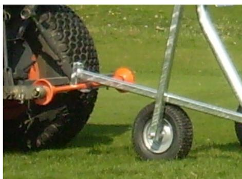
La barre d'attelage du tracteur est accrochée dans ce crochet et le tube PE est détaché.
