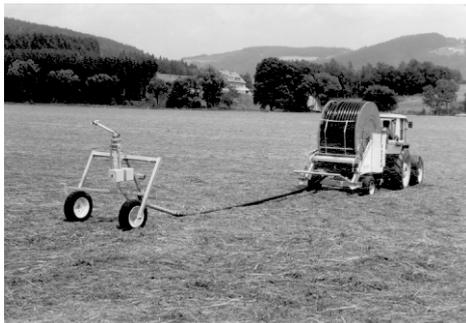
Descendez le traîneau conformément à la description sous schéma d'opération I, chapitre " Descendre le traîneau " et ancrez-le légèrement. Ensuite conduisez l'appareil à travers le champ.
