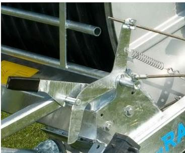
L'appareil est équipé d'un arrêt final ainsi que d'un arrêt de sécurité qui rendent inutile la surveillance de l'opération d'arrosage. L'arrêt final répond dans le moment où le traîneau pousse contre la barre palpeur qui, à l'intermédiaire d'une timonerie, actionne le levier de changement de vitesse. L'entraînement est arrêté. Pour éviter des inconvénients lorsque le tube PE est mal enroulé, la barre palpeur déclenche également l'arrêt.
